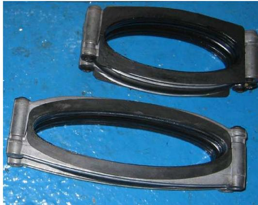
4. Démontage des supports de l'intercooler ci-dessous avec une clé six pans de 4
