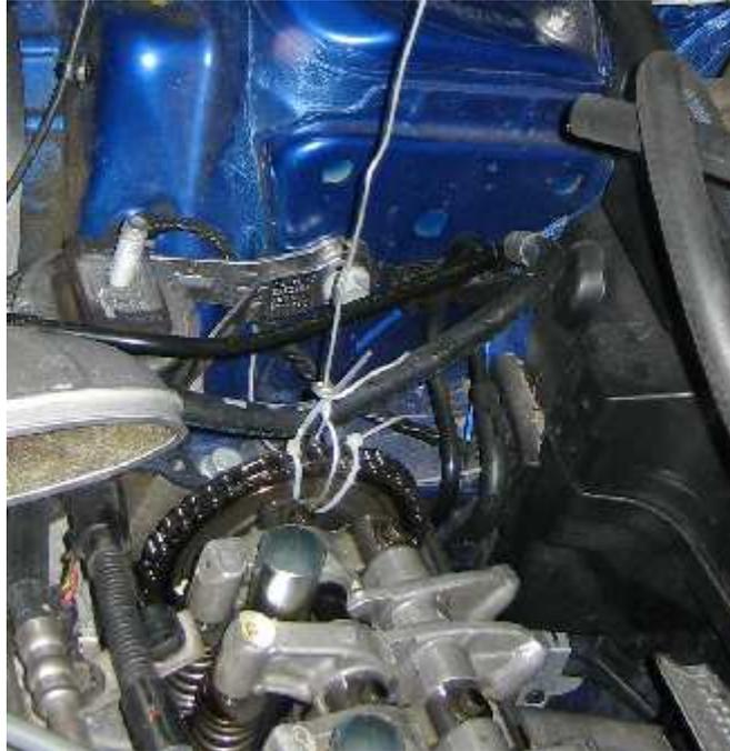
23. Sortir la couronne en tirant simplement dessus, il y a un ergot pour la position de l'AAC / couronne donc aucun problème pour le positionnement lors du remontage.
