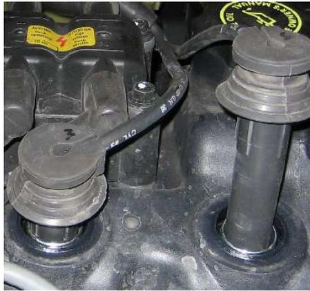
6. Débranche la bobine HT, tiré d'abord sur la languette rouge vers la gauche puis retirer le connecteur en le tirant vers le fond
